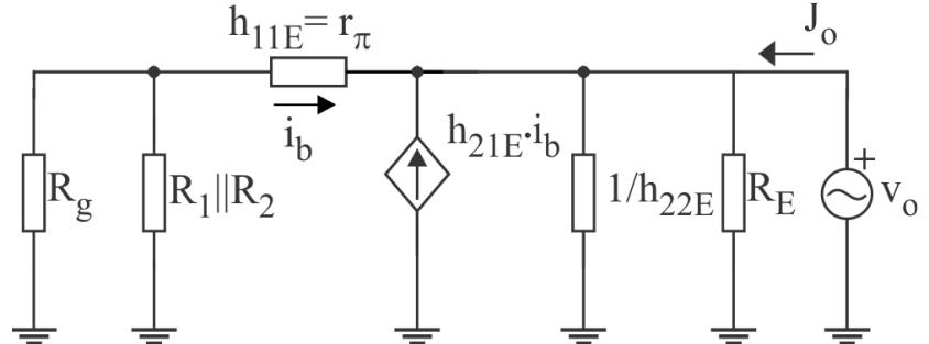
$$i_o = \frac{v_o}{R_E} - h_{21E} \cdot i_b - i_b + v_o \cdot h_{22E}$$
