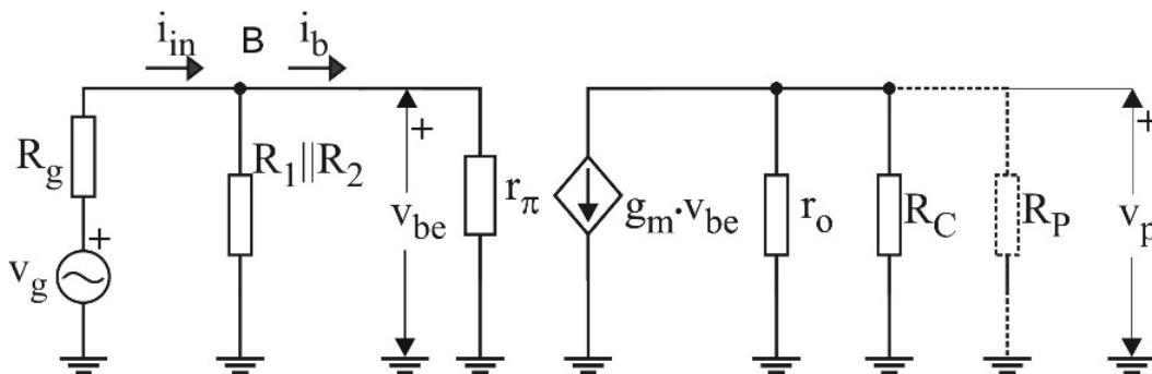
Primenom teoreme o kompenzaciji možemo da zamenimo realni generator sa idealnim naponskim generatorom čija je elektromotorna sila jednaka naponu na bazi  $v_b$ .
