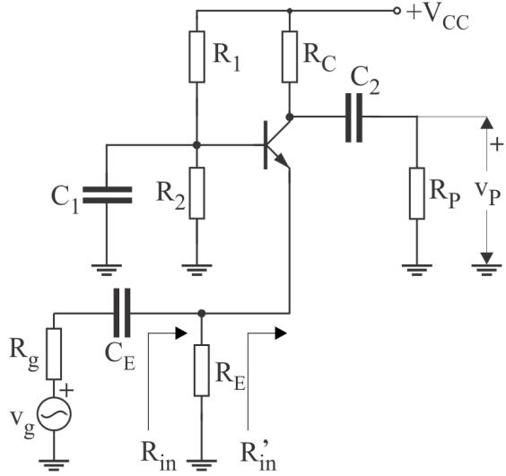
Sa  $R_{EB}$  je označena ekvivalentna otpornost između izlaznih priključaka tranzistora:
