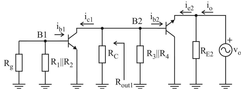
Najpre se određuje izlazna otpornost prvog pojačavačkog stepena  $R_{out1}$ , a nakon toga izlazna otpornost drugog pojačavačkog stepena
