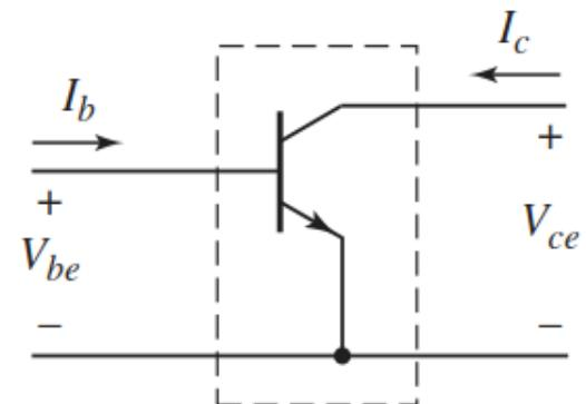
Ukoliko se zadaju dve od ove četiri veličine preostale dve zavise samo od karakteristika komponente. U praksi se za modeliranje bipolarnog tranzistora najviše koriste h-parametri, za koje su nezavisno promenjive ulazna struja  $i_B$  i izlazni napon  $v_{CE}$ .
