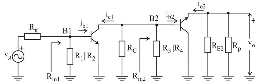
Najpre se određuje ulazna drugog pojačavačkog stepena  $R_{in2}$ , a nakon toga ulazna otpornost prvog pojačavačkog stepena.
