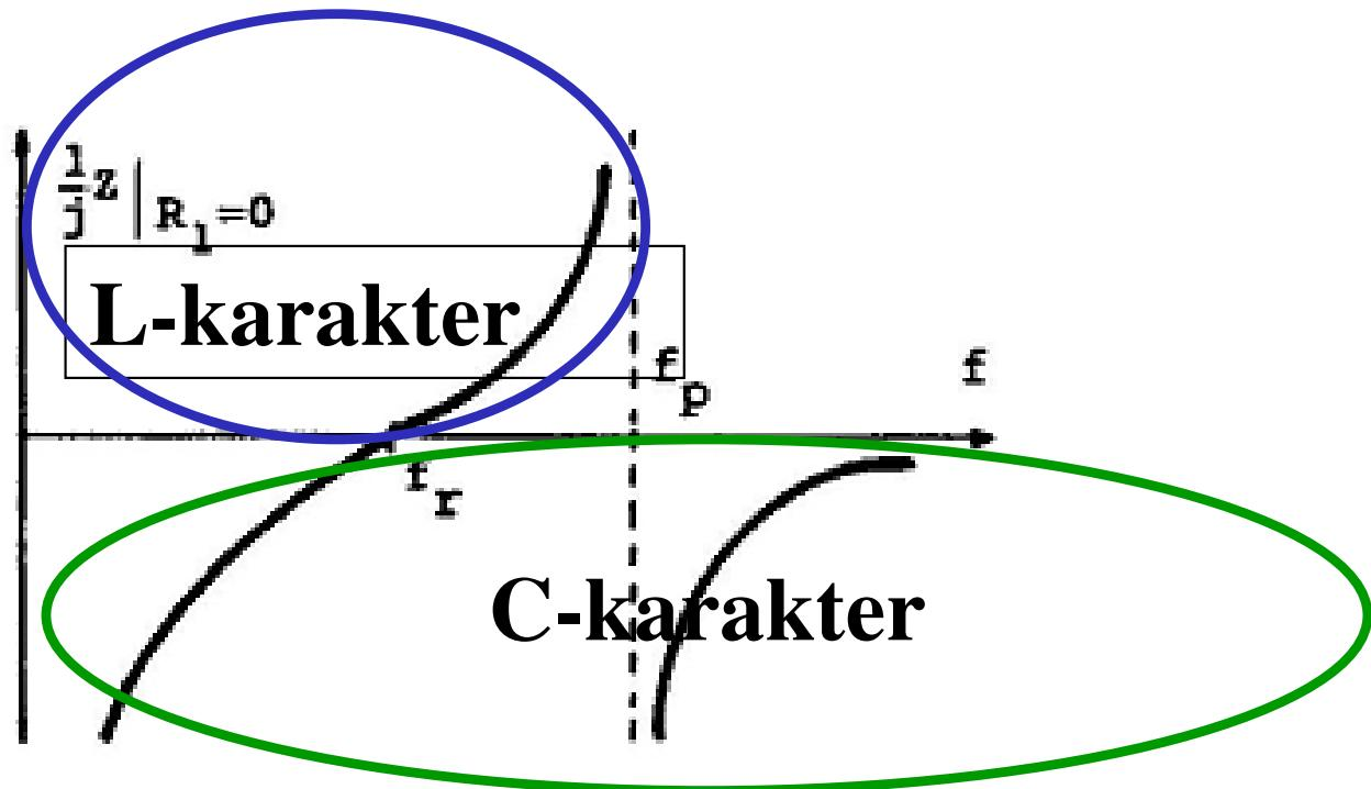
Na frekvencijama nižim od redne rezonantne frekvencije i višim od paralelne rezonantne frekvencije kristal kvarca se ponaša kao kapacitivnost (negativna vrednost reaktanse). Između frekvencije redne i paralelen rezonanse ponaša se kao induktivnost (pozitivna vrednost reaktanse).
