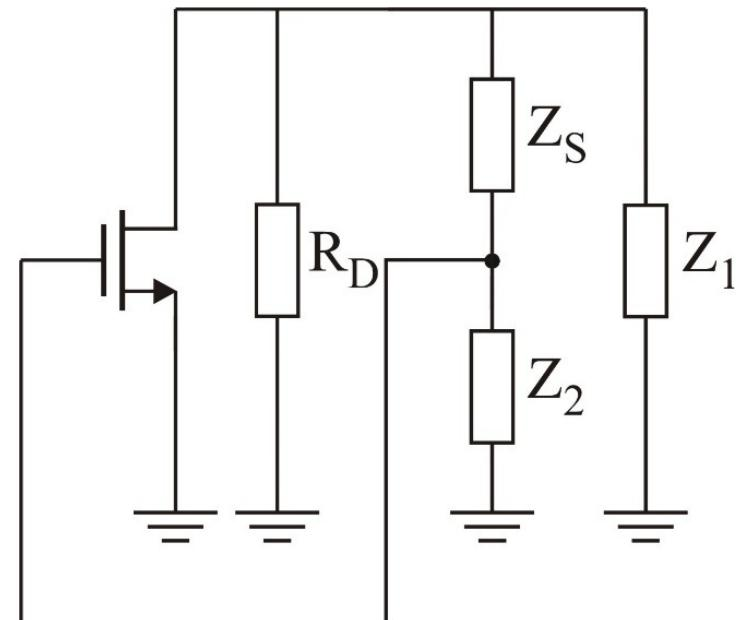
Kod ovog tipa oscilatora aktivni element je povezan sa kolom povratne sprege koje sadrži tri reaktivna elementa:  $Z_1$ , paralelno sa izlaznim pristupom,  $Z_2$  paralelno sa ulaznim pristupom i  $Z_s$ , čiji krajevi su između izlaza i ulaza pojačavača. Odnos reaktansi  $X_1$  i  $X_2$  određuje uslov oscilovanja. Kao aktivni element može se koristiti MOSFET, bipolarni tranzistor ili operacioni pojačavač.
