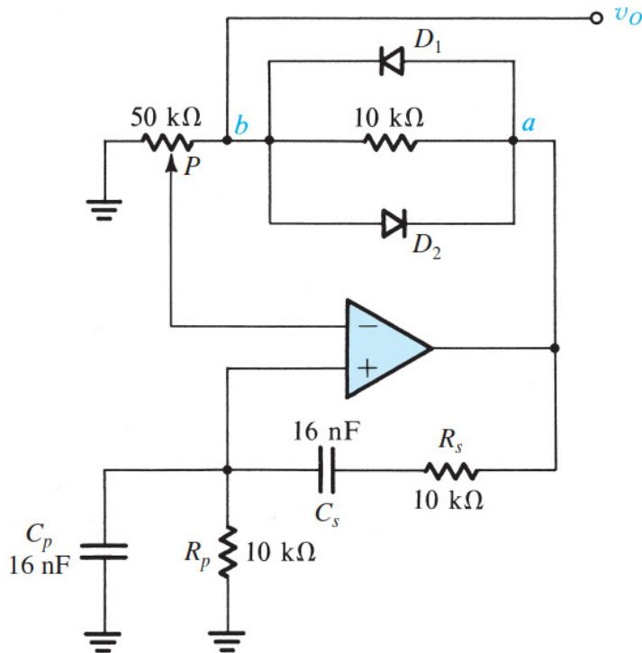
Da bi sprečili ulazak kola u zasićenje, odnosno da bi kolo nastavilo da radi u linearnom režimu rada dodaju se nelinearna kola za kontrolu amplitude. Ova kola se nazivaju limiteri jer ograničavaju vrednost amplitude signala na izlazu. Limiteri se najčešće sastoje od dioda.
