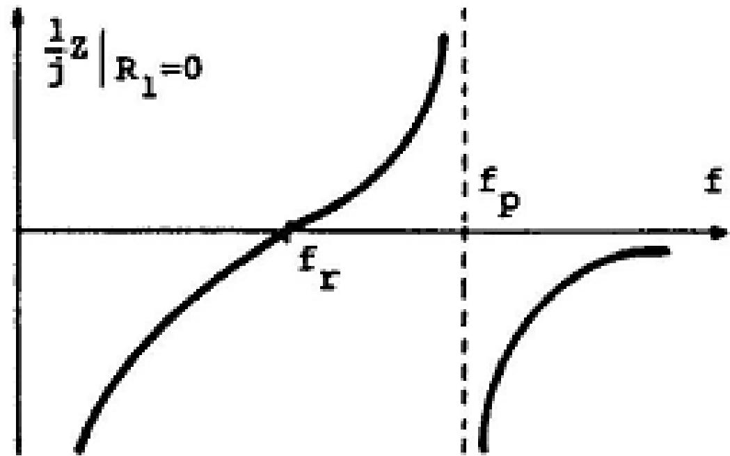
S obzirom da je razlika između rezonantnih frekvencija vrlo mala (od nekoliko Hz do nekoliko stotina Hz) frekvencijski opseg unutar koga se kristal kvaraca ponaša kao induktivnost je vrlo mali. Unutar tog frekvencijskog opsega induktivnost se menja u vrlo velikim granicama.
