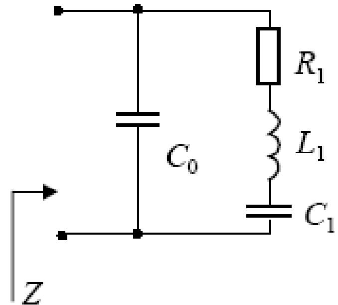
Sam krital kvaraca se ponaša kao redno oscilatorno kolo. Induktivnost u ekvivalentnoj šemi zavisi od mase kristala, kapacitivnost od elastičnosti, a otpornost od kvaliteta izrade. Kapacitivnost  $C_1$  je reda femtofarada, a  $C_0$  reda pikofarada.
