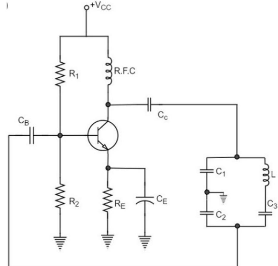
Dodatakom kondenzatora  $C_3$  na red sa kalemom L poboljšava se stabilnost oscilacija jer se smanjuje uticaj parazitnih kapacitivnosti aktivnog elementa. Ove parazitne kapacitivnosti su praktično pridodate kapacitivnostima kondenzatora  $C_1$  i  $C_2$ .
