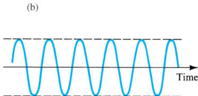
Pre nego što se uspostave oscilacije kolo je nestabilno jer se polovi kružnog pojačanja nalaze u desnoj poluravni kompleksne učestalosti (gornja slika). Amplituda oscilacija raste. Usled porasta amplitude pojačavač dolazi u nelinearnu oblast rada što ima za posledicu pomeranje polova ka imaginatnoj osi. Kada se to desi uspostavlja se konstantna vrednost amplitudne oscilacija (donja slika).
