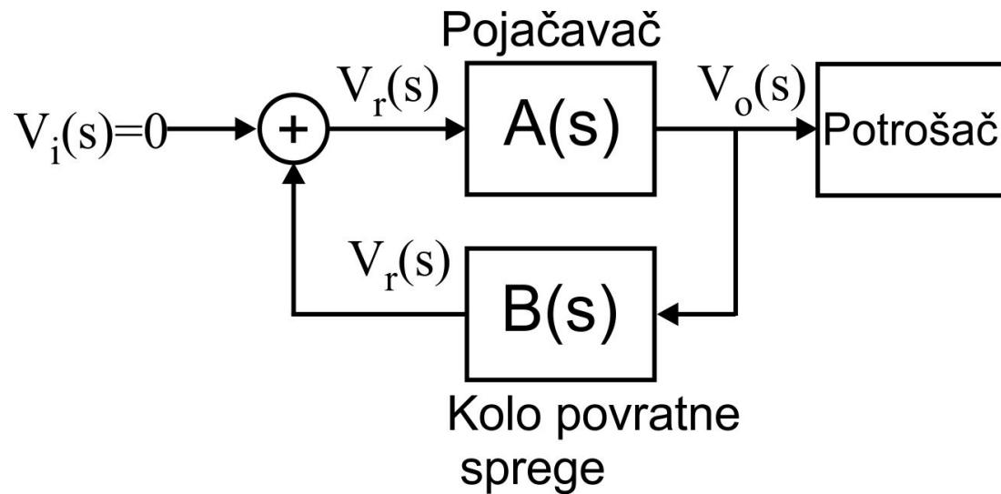
$$A_r(j\omega) = \frac{V_o(j\omega)}{V_i(j\omega)} = \frac{A(j\omega)}{1 - A(j\omega) \cdot B(j\omega)}$$
