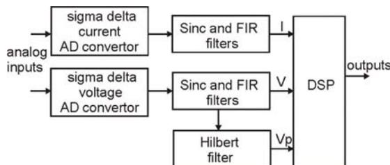
Figure 1. Energy Power Meter System-on-Chip
