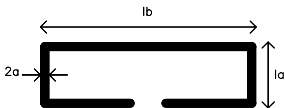
Sl. 2: Izgled štampane loop antene
